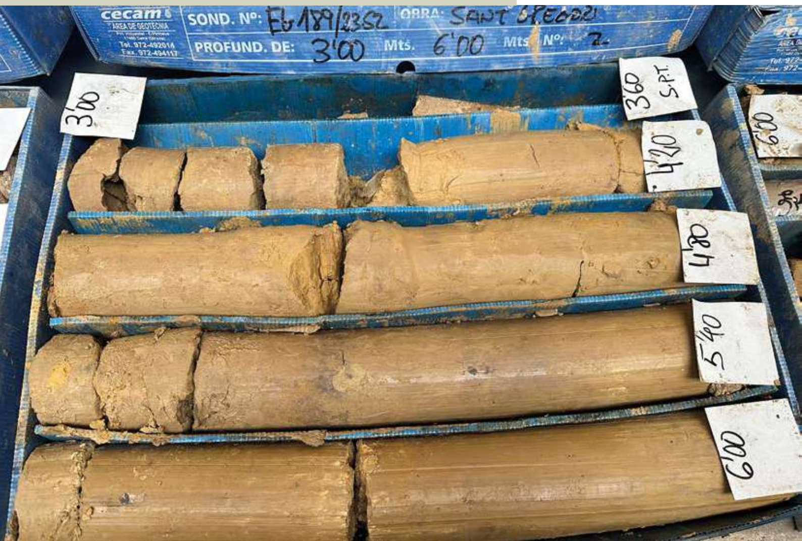
Caixa amb testimonis d'argiles expansives (Sant Gregori).
